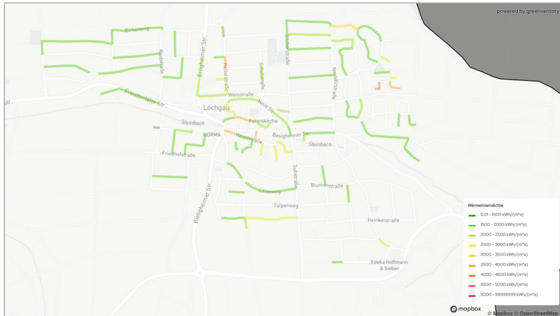
Abbildung 9: Wärmelinienichten ab 1.500 kWh/m
